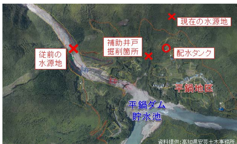
図 11.22 平鍋地区における水源地の被災状況
