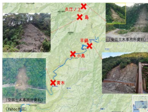
図 11.14 奈半利川周辺の主な崩壊箇所
