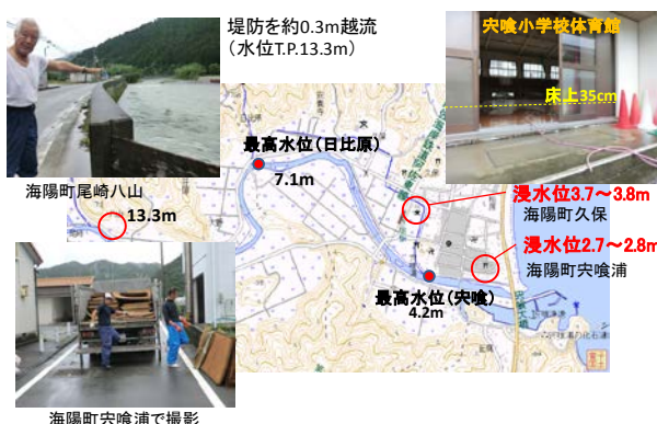
図 2.2 穴喰川周辺の浸水状況
