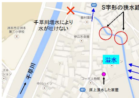
図 13.4 被災要因（洲本市上物部地区）
