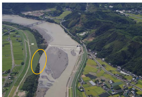
写真 7.4 那賀川 10.2k 北岸堰下流の河岸侵食 (右: 国交省提供へり画像)
