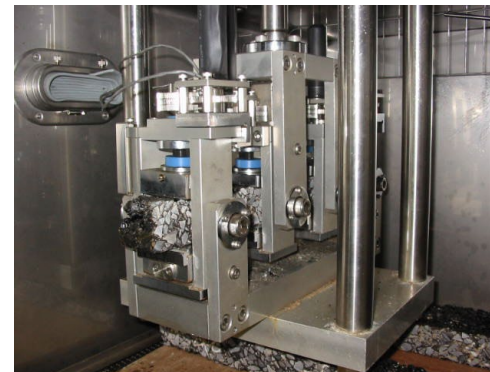
室内試験の例(4点曲げ疲労試験)
