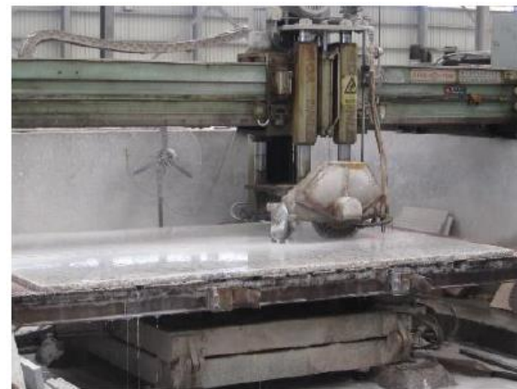
写真-1.16 所定寸法に切断(ダイヤモンドカッター)
