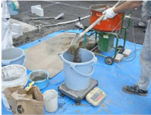
砂・水・セメントの計量(砂の含水比から事前に加水量を決める)
