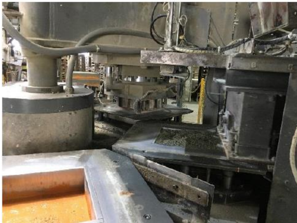
写真-1.27 表層材の上に基層材を投入してプレス
