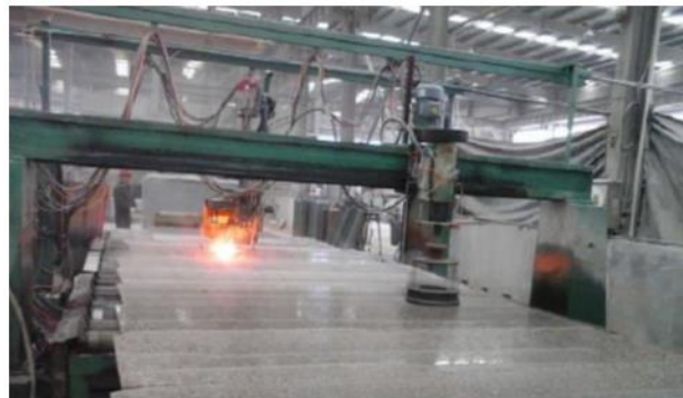
写真-1.19 バーナー仕上げ (2000°C前後の高温バーナー炎を石材表面に吹付け)
