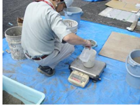
砂・水・セメントの計量(砂の含水比から事前に加水量を決める)
