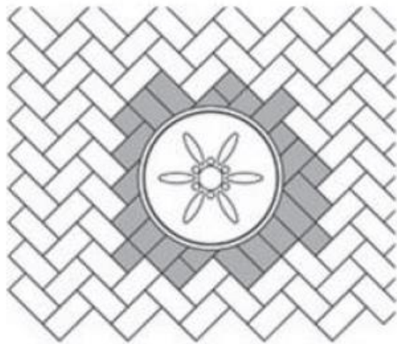
セグメンタルタイプの納め方の例
