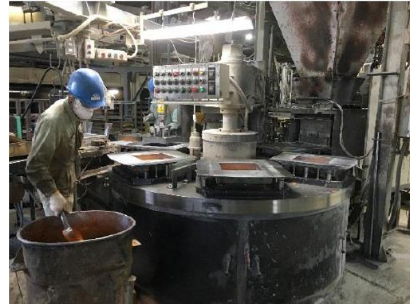
写真-1.26 表層材を型枠に投入
