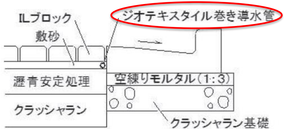
＜ジオテキスタイル巻き導水管を用いた例＞
