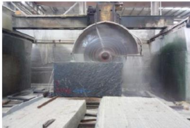
写真-1.15 原石の加工(ダイヤモンドカッター)
