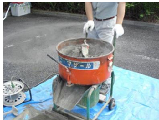
砂 → 水 → セメントの順でミキサに投入、練り混ぜ
