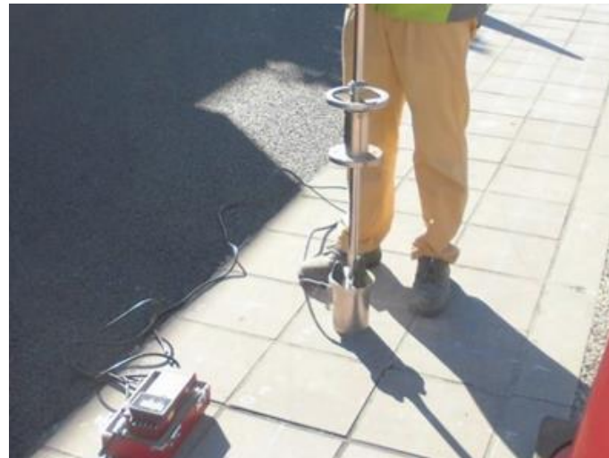
写真-3.13 小型FWD試験(支持力調査)
