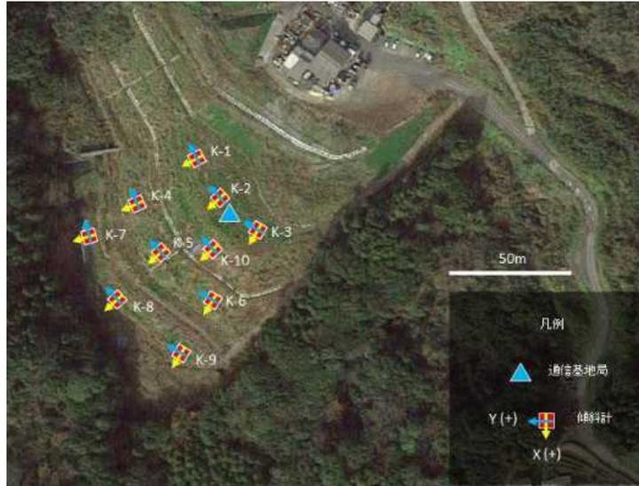
図 4.2.6 センサ敷設位置と傾斜計の方向
