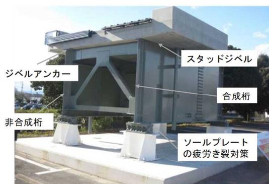
図 4.4.7 鋼桁モデルの外観図
