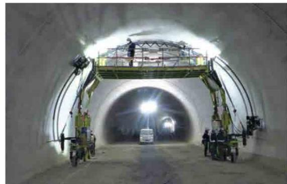
図 2.2.3 トンネル全断面点検システム
