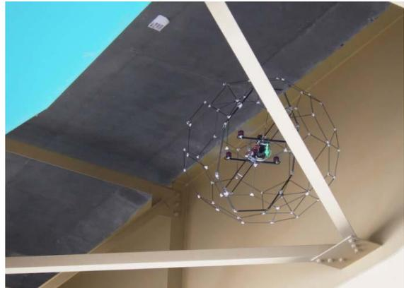
図 2.2.2 球殻フレーム付き点検ドローン
