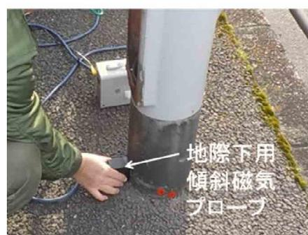
図 4.2.3 照明柱の高感度磁気非破壊検査の状況
