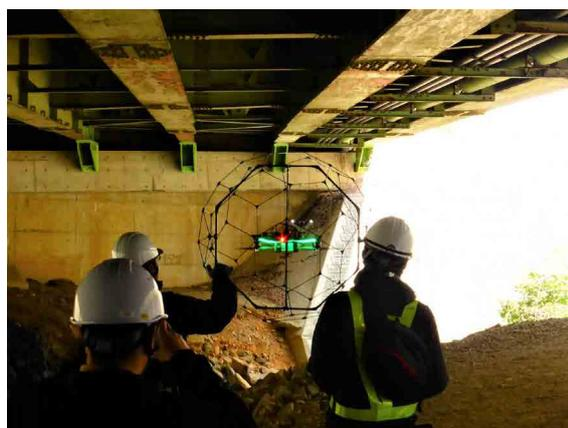
図4.4.2 球殻ドローンの実証実験
