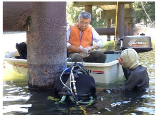
図 4.2.4 極低周波渦電流検査装置による計測
