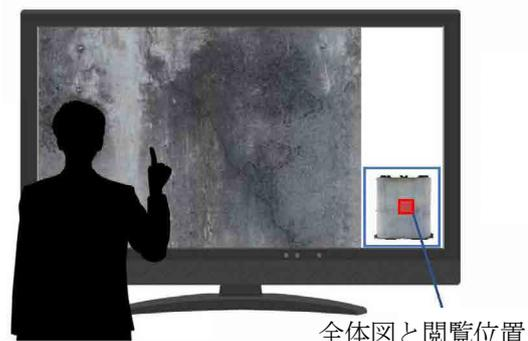
図 4.3.7 大型タッチパネルによるバーチャル近接目視点検
