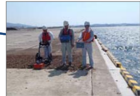
舗装下の空洞化探査 （電磁波レーダなど）
