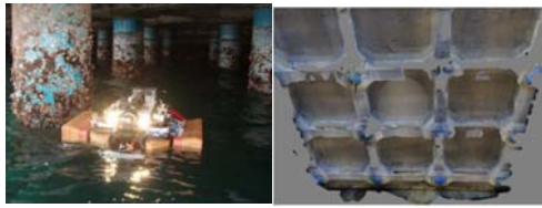
② 棧橋上部工点検用ROV 点検診断支援ソフト
