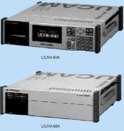
データロガーUCAM-60Aは、使い易さを追求した現場対応型。ルインワン測定器です。採集しやすい、分かりやすい日本語表示、明るく見やすいディスプレイ、測定結果がすぐ分かるプリンタ付きと、現場測定に必要な機能が満載されています。
