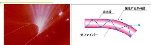
工学ストランドは、3本の光ファイバーをより線にして作成したもので、その中を通過する光は、その通路に曲り (マイクロベンディング) があると、その部位で光が外部に漏れ、ファイバー内部を通過する光の強度は減少する。このマイクロベンディングの原理を用いて、光の漏れ量を検出することで、構造物の変形や歪みを測定する。
