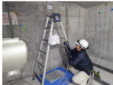
図-2.1 土嚢による衝撃加振状況
