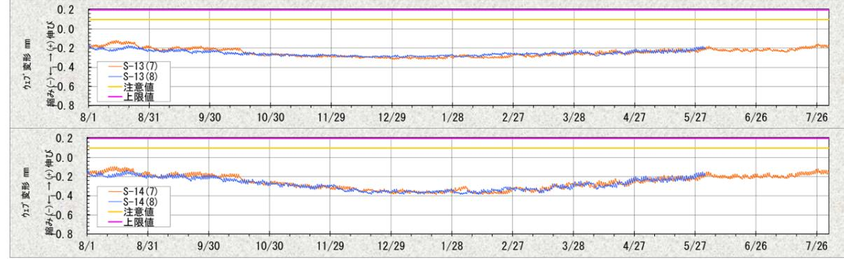
② 垂井高架橋 橋脚付け根部ウェブ変形 計測結果
