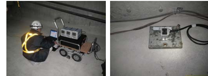
図-3.1 振動測定状況および加速度計設置状況
