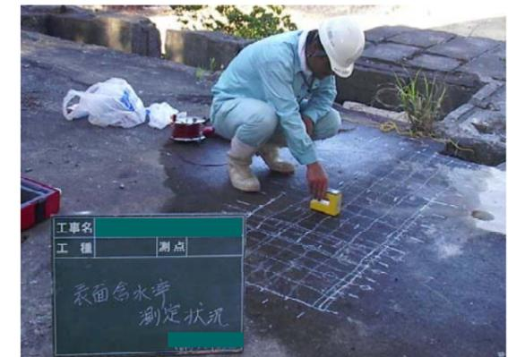
写真2 表面含水率測定状況
