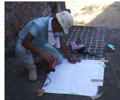
写真1 鉄筋探査状況
