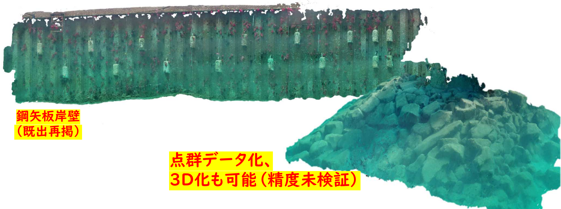
基礎捨石マウンド(上方からカメラを下向きにして撮影したもの) (初出、論文掲載なし)
