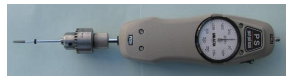
写真-解2 荷重測定器付きドライバー
