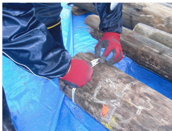
写真-3 周長計測状況 4)
