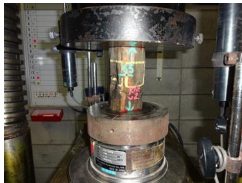
写真-解 4 縦圧縮試験の一例
