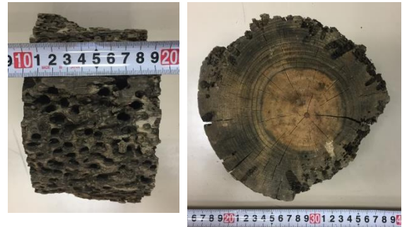
写真-解7 コツブムシ食害を受けた水制工のアカマツ丸太杭 35)
