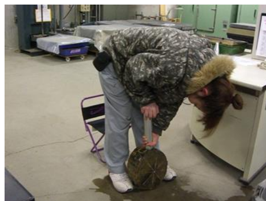
写真-6 ピロディン試験状況
