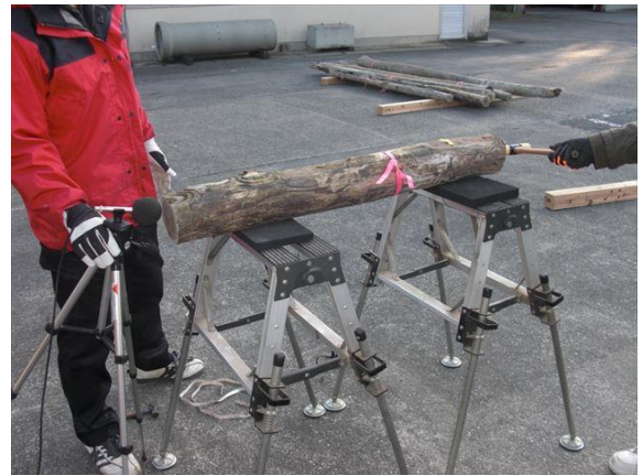
写真-解 3 縦振動試験の一例 4)
