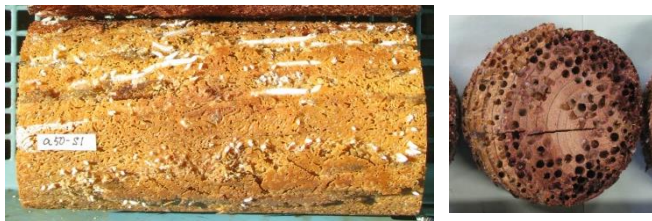
写真-解6 フナクイムシ食害とキクイムシ食害を受けたカラマツφ10cm 円柱材 36)
