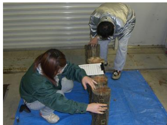
写真-4 腐朽度の判定状況
