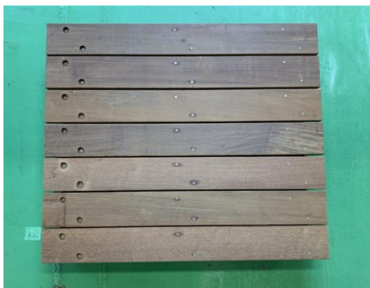
写真-3 床板材の固定
