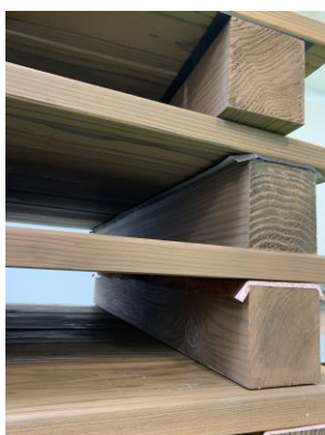
写真-2 上からゴム, ガリバリウム鋼板, 銅板を挟んだデッキ版
