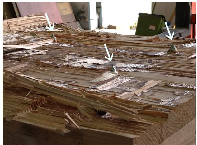
図-8 割れが生じた積層面
