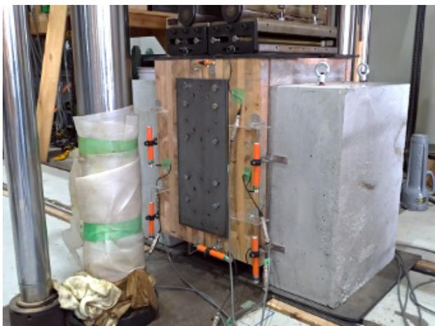
図-1 CLT-コンクリート接合部試験体
