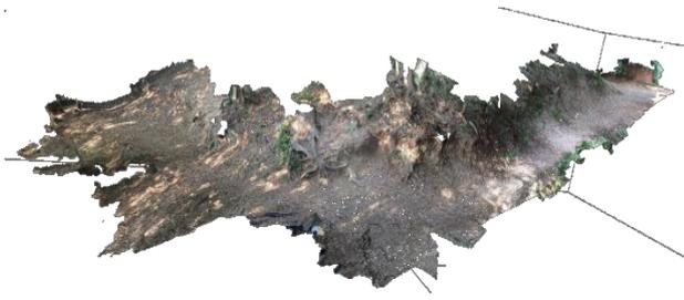
図-3 写真測量の結果（円曲線の12m部分）
