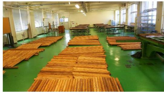
写真-6 部材の養生の様子
