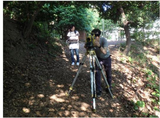
写真4 電子平板での測量の様子
