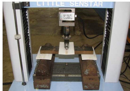
写真-2 曲げ載荷の状況
