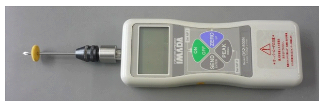
写真-7 ドライバーを装着した荷重測定器
