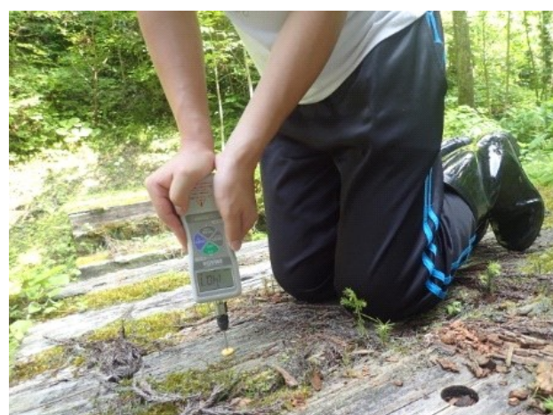
写真-8 荷重測定器を用いたドライバーの測定状況
