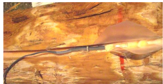
写真-1 ひずみゲージの取り付け状況
