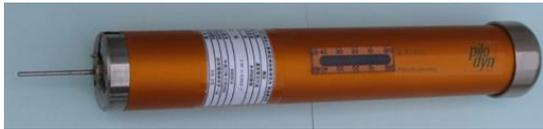
写真-2 ピロディン試験器
