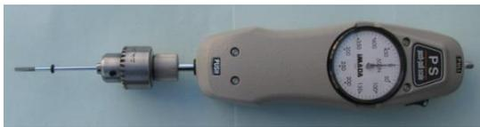
写真-3 ドライバー+荷重測定器
