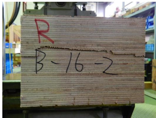
写真-6 LVL まくらぎのせん断破壊(シラカンバ, 平使い)
