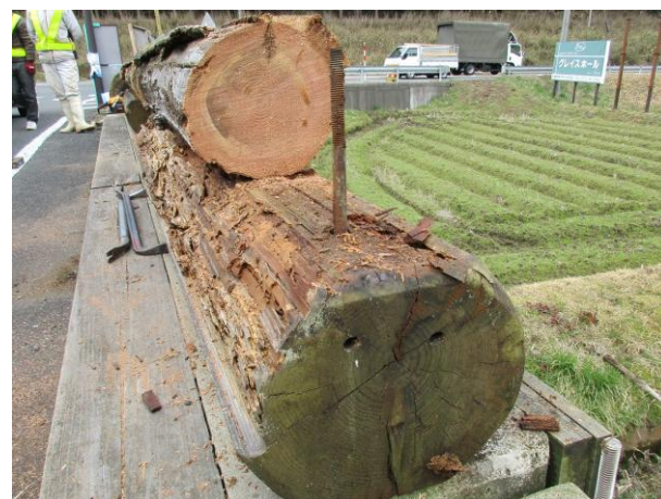
写真-10 駒止材の断面（2015 年）
