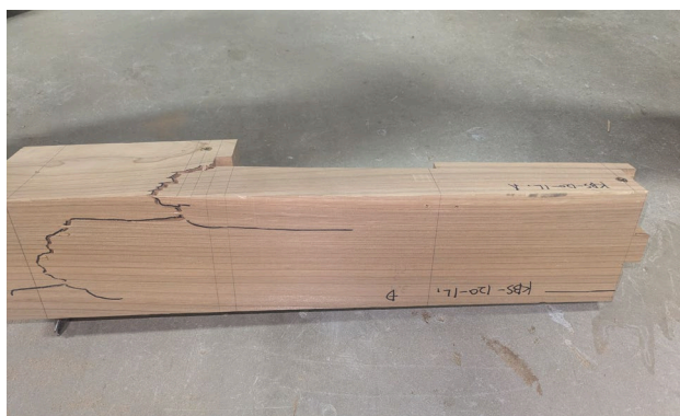
写真-1 鎌の付け根で曲げ破壊した試験体
