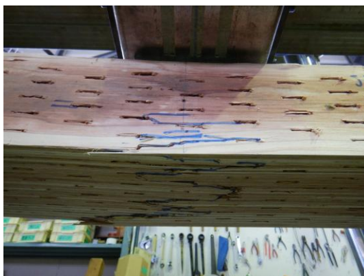
写真-5 LVL まくらぎの曲げ破壊(スギ, 縦使い)
