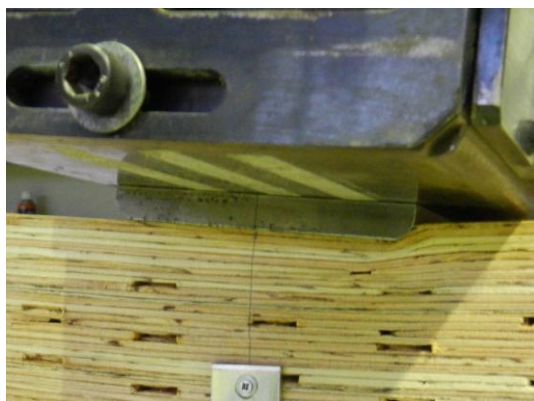
写真-7 加圧部に設けた鋼板のめりこみ(平使い LVL, カラマツ)
