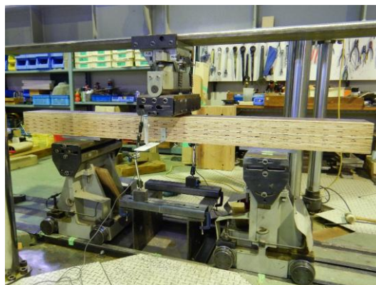
写真-4 まくらぎの曲げ試験の実施状況
