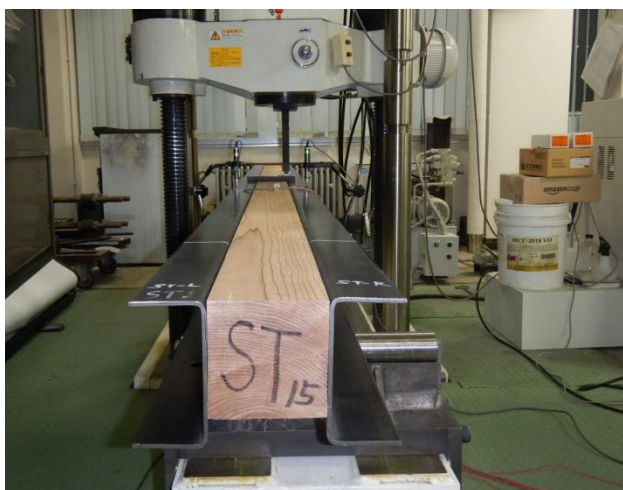
写真-1 載荷装置と試験体
