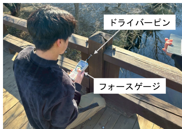
図-8 ピン貫入試験の様子
