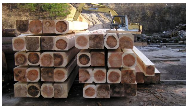
写真-3 製材後の桁材
