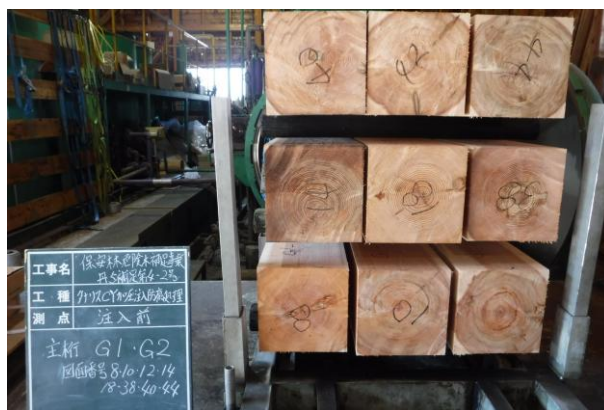
写真-20 製材された主桁材
