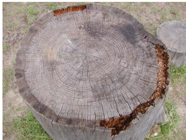
写真-2.2.4 辺材部のみが腐朽した 大断面のスギ丸太
