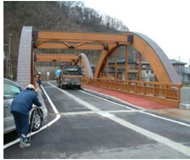
写真-5.1.10 八幡橋の振動試験
