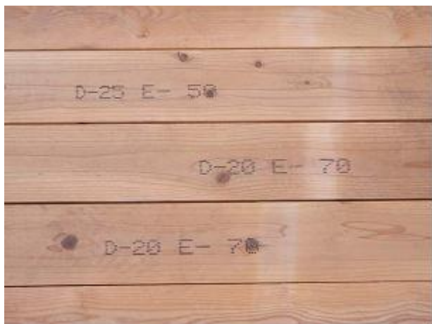
写真-4.5.1 機械等級区分材の表記の例
