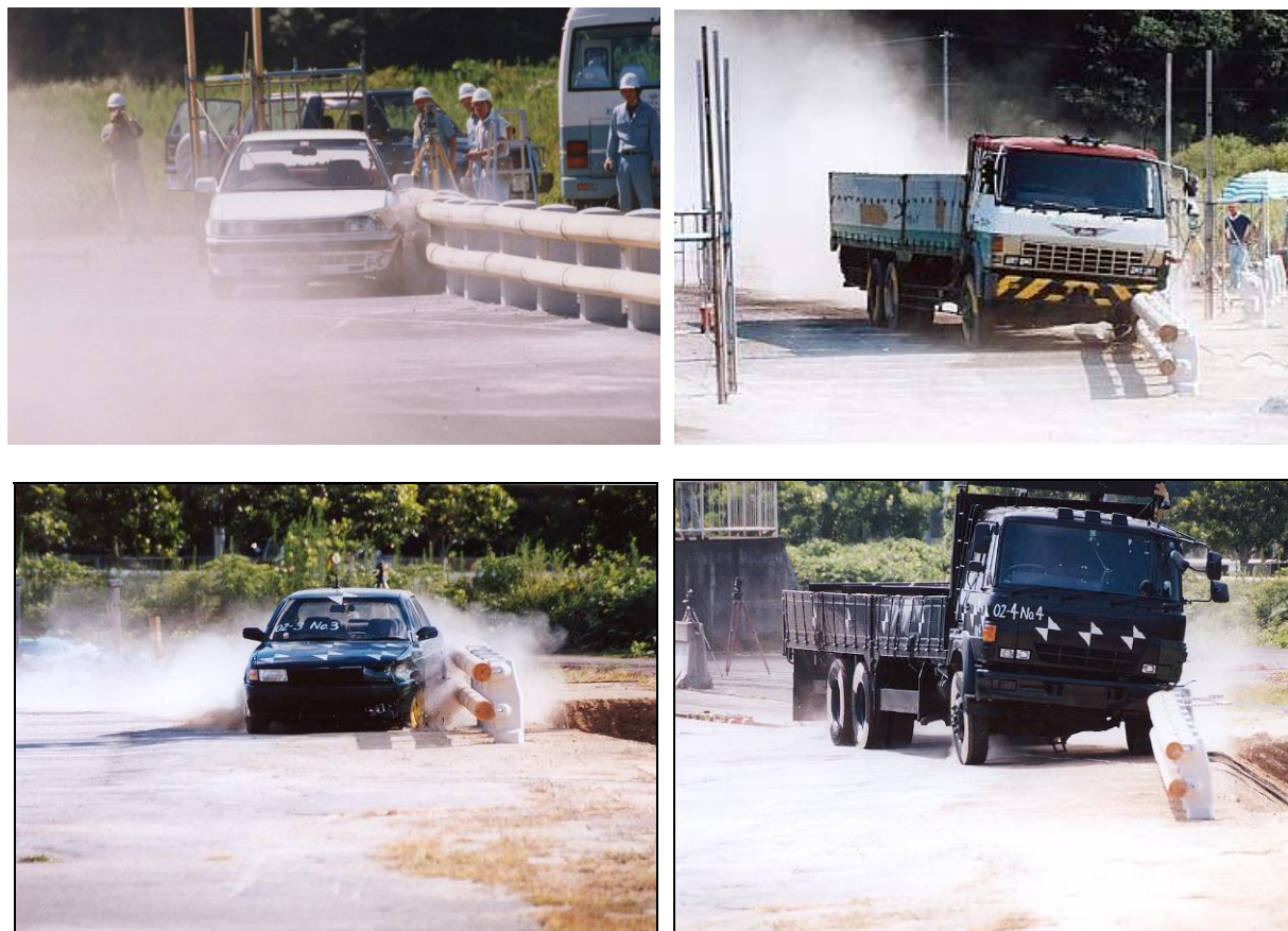
写真-8.1.1 実車衝突試験実施状況(上：予備試験，下：公的試験)
