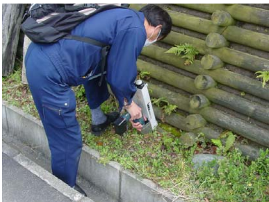
写真-6.3.2.9 穿孔抵抗試験機による計測（根来山）
