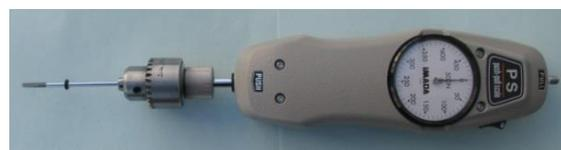
写真-解2 荷重測定器付きドライバー
