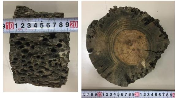
写真-解7 コツブムシ食害を受けた水制工のアカマツ丸太杭<sup>35)</sup>
