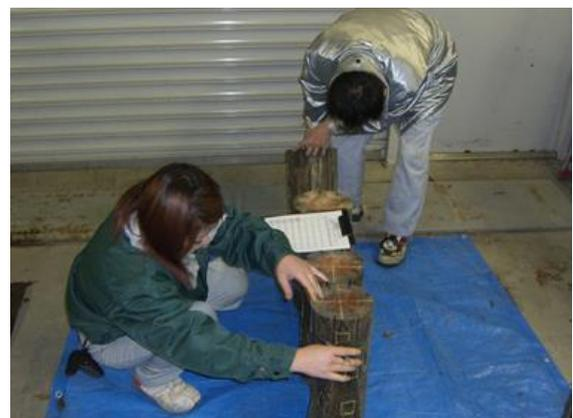
写真-4 腐朽度の判定状況
