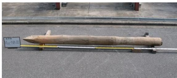
写真-解10 丸太の写真撮影の一例
