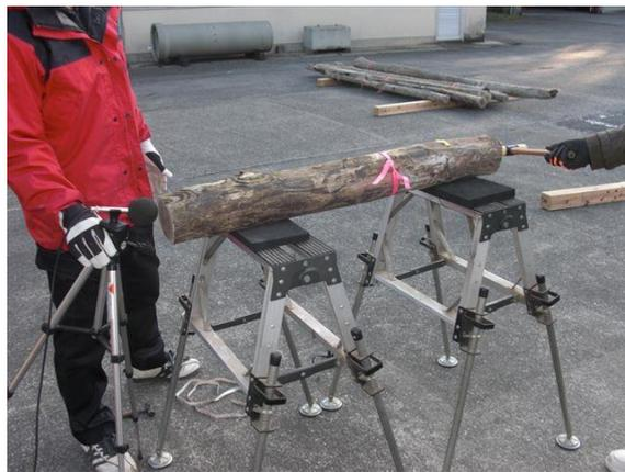
写真-解 3 縦振動試験の一例<sup>4)</sup>
