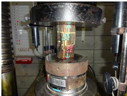
写真-解 4 縦圧縮試験の一例
