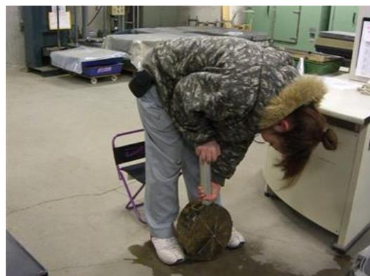
写真-6 ピロディン試験状況
