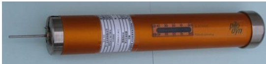
写真-2 ピロディン試験器
