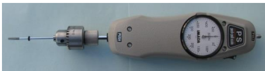
写真-3 ドライバー+荷重測定器
