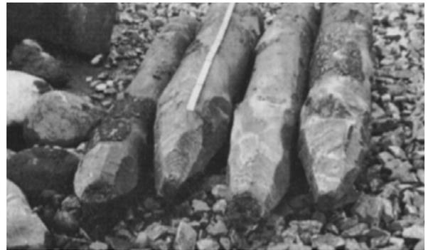
写真-2.9 基礎木杭の先端の状態
