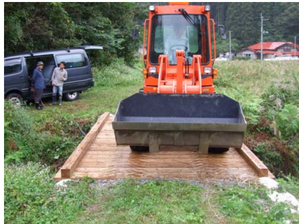
写真－9 現地載荷試験の様子
