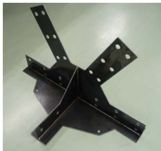
写真-4 鋼格点部材
