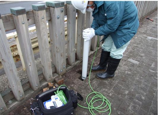
場所 床版および主桁上面の穿孔抵抗測定
