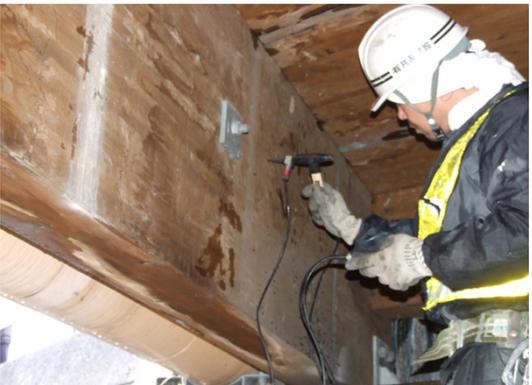
場所 集成材主桁の応力波伝搬速度測定
