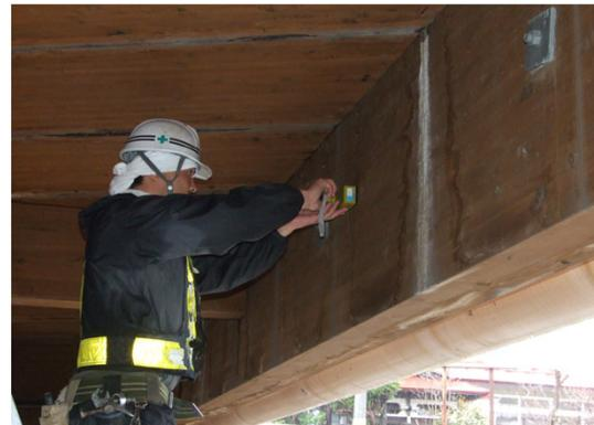
場所 集成材主桁の含水率測定
