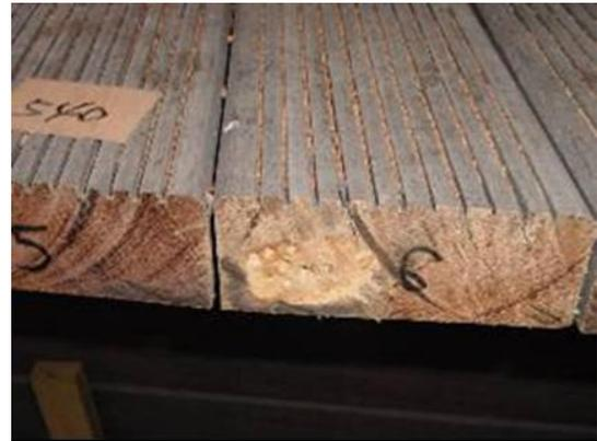
写真-15 床板内部で繁殖している白色腐朽菌
