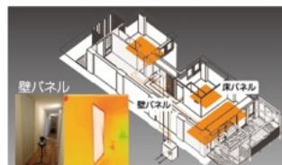
暖冷房システムの効率化 「地下水&太陽熱を活用した壁/床パネル」
