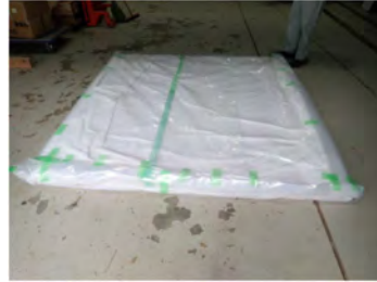
真空プレス接着の様子
