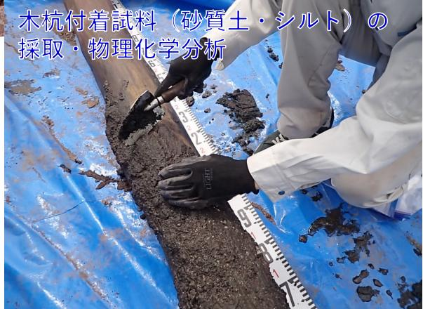
木杭付着試料(砂質土・シルト)の採取・物理化学分析
