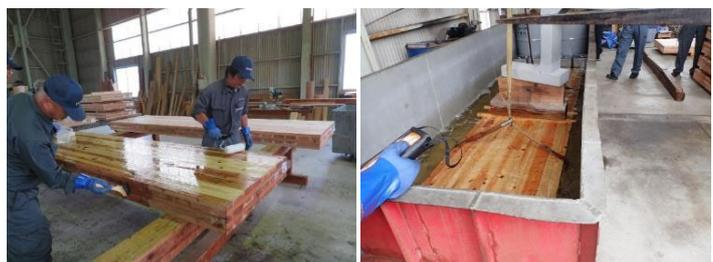
CLTの塗布・浸漬処理の事例
