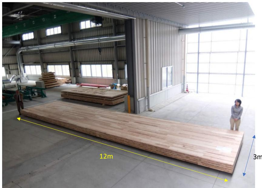
国内で製造できる一番大きなサイズ (3m×12m) のスギCLTパネル (銘建工業：岡山県)
