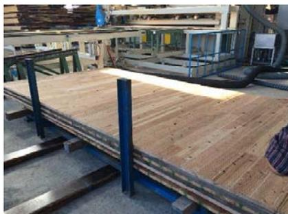
処理ラミナを用いたCLTの製造の様子
