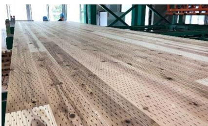
CLT工場で製造したインサイジングラミナを用いたCLT (約2000×8000mm)
