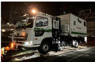
(受賞理由) 日本で唯一の軌陸式レール探傷車を開発。超音波によるレール内部の傷の調査、レール摩耗を標準軌および狭軌の線路幅によらず測定できる日本で初めてのレール探傷車であり、高い機動性と安定した探傷データの提供により、鉄道インフラの維持管理に貢献した。
