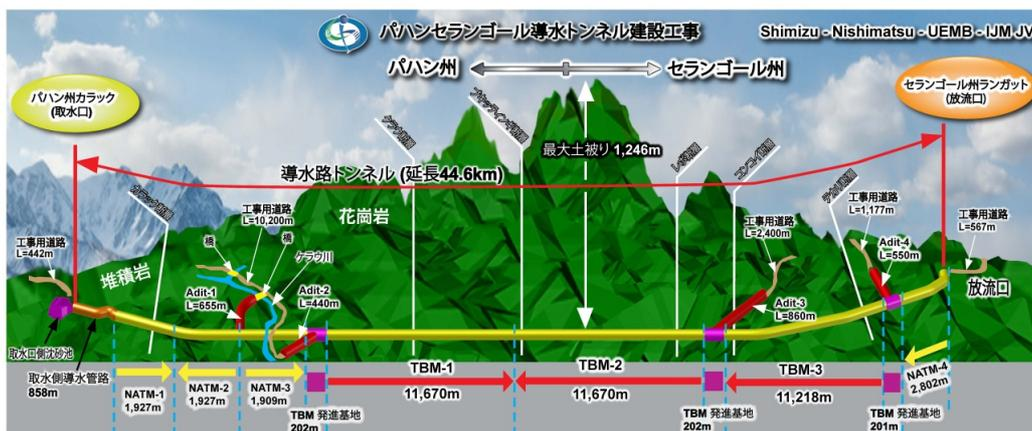
図 2 トンネル縦断面図 (マレーシア国パハン州、セランゴール州)
