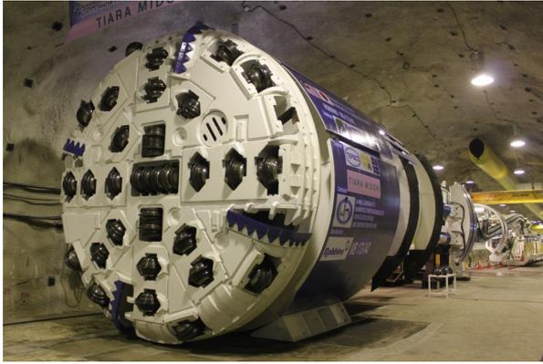
図3 トンネルボーリングマシン (TBM)
