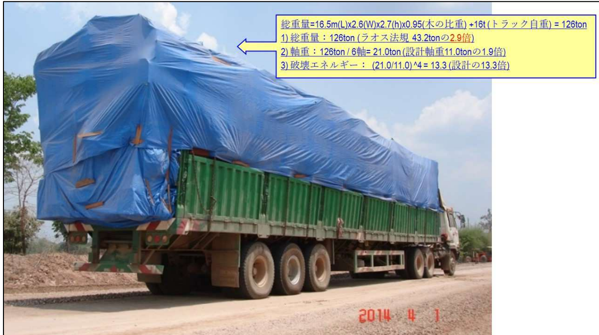
加工角材運搬の過積載トレーラ（重すぎて道路の真ん中で故障）
