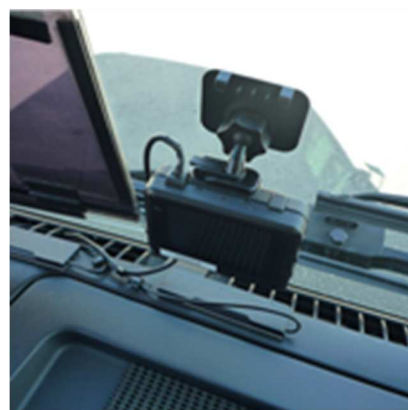
写真4 ドラレコ設置状況
