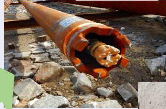
ウォータージェット 配管先端を突出
