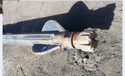
中心維持する為の翼の取り付け（加工）
