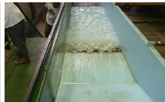
水理模型実験(遊水地の越流堤の減勢工の緒元確認)
