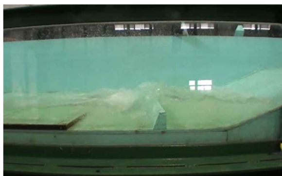
水理模型実験(遊水地の越流堤の減勢工の緒元確認)
