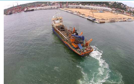
トレーラーサクシオン浚渫船(シンガポール)
