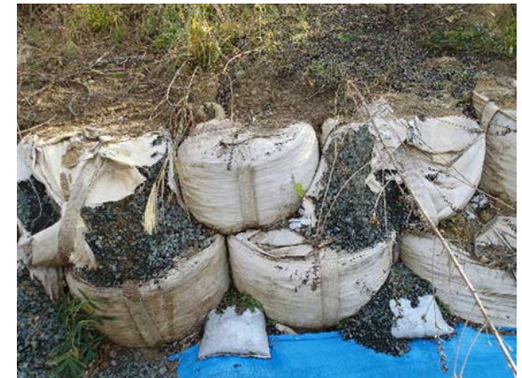
耐候性大型土のう（紫外線吸収剤使用） 耐用年数：3年程度
