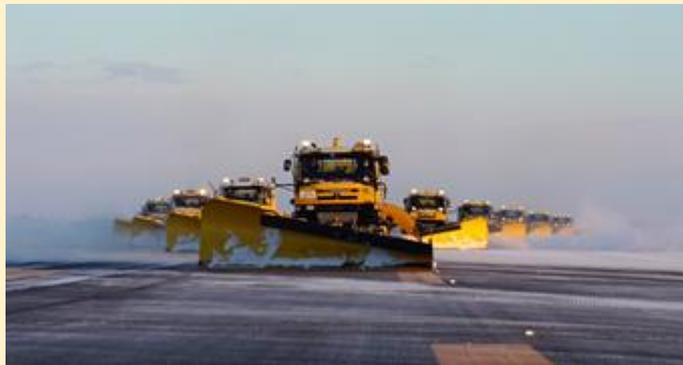
図 23 新千歳空港における除雪車の雁行態勢による除雪作業の様子
