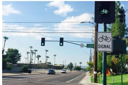
② 自転車専用交通信号(米国アリゾナ州・フェニックス市、160 万人、自転車に他車両より早く青信号を表示し、早めに自転車を発進させる)
