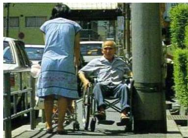
図 2-1-7 電柱が歩行空間を狭め、歩行阻害となっている例<sup>28)</sup>
