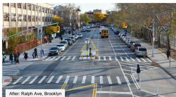
① 15mph 速度制限、スピードハンプの設置      ② 歩道を広げて横断距離を短縮、安全島を設置
