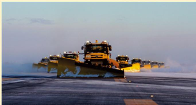
図 23 新千歳空港における除雪車の雁行態勢による除雪作業の様子
