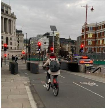
⑤自転車道から信号交差点に接近する箇所で、速度の低下を促す障害物を設置（英国ロンドン、970 万人）
