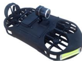
図 17 管路点検用ドローンの例 33
