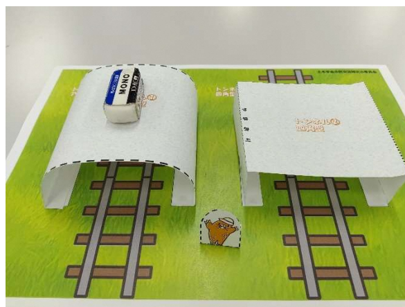
トンネルの強さの確認方法の例
