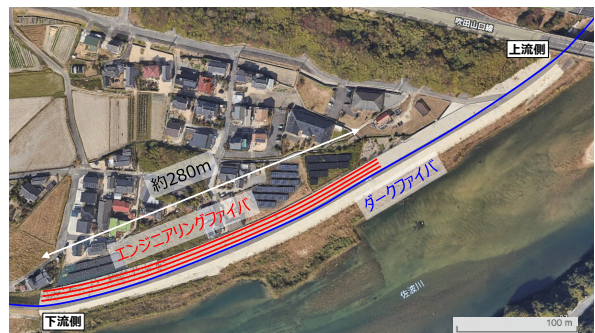
図-6 エンジニアリングファイバのレイアウト
