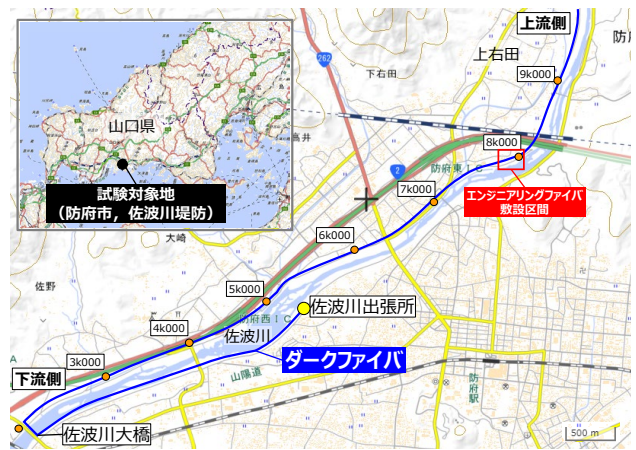
図-4 本試験で用いた光ファイバのレイアウト
