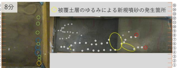
図-5 水みち進行度 (堤体中央・決壊直前) によって分けた水みちの個所と漏水の強弱
