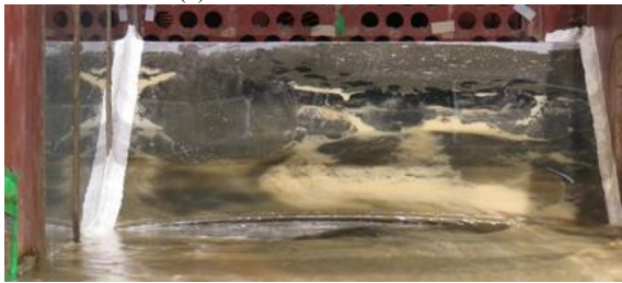
(iii) 越水開始から 10 分経過 図 5 のり面変状 (C-2)
