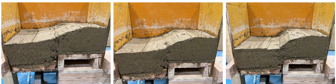
(d) 段差 3cm (e) 段差 4cm (f) 段差 5cm
