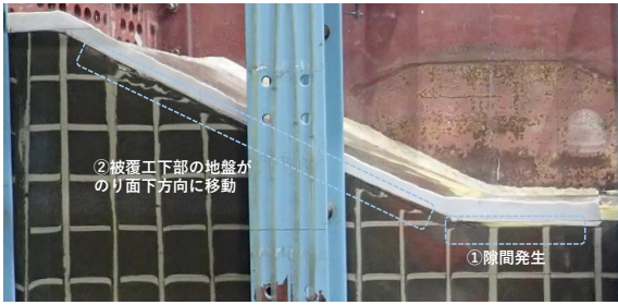
図 4 側面からの変状の様子 (越水開始から 10 分経過)
