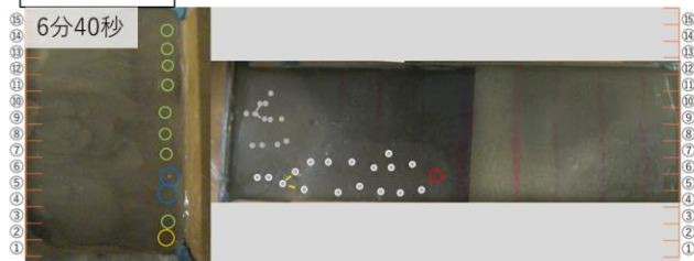
図-5 水みち進行度 (堤体中央・決壊直前) によって分けた水みちの個所と漏水の強弱
