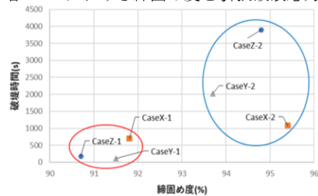
図 5 各 Case における締固め度と破堤時間の関係
