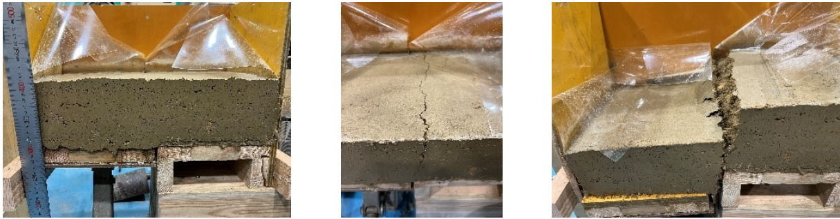
(a) 段差無し (b) 段差 2cm で亀裂の確認 (c) せん断破壊
