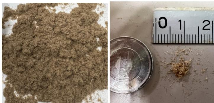
図-3 長さ 0.3-1.0mm に切断した短繊維材（麻繊維）
