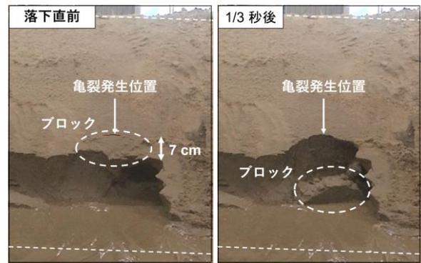
図-8 ブロック破壊の変状の様子 (設定水位に達してから約 148 分後)
