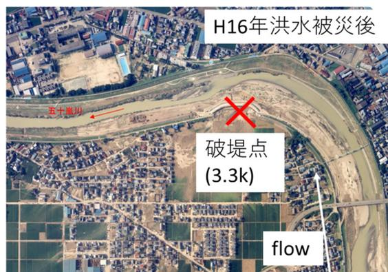
図-1 平成 16 年 7 月新潟・福島豪雨における破堤点<sup>4)</sup>
