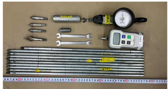
図1 VC試験に用いた試験機器の全体構成
