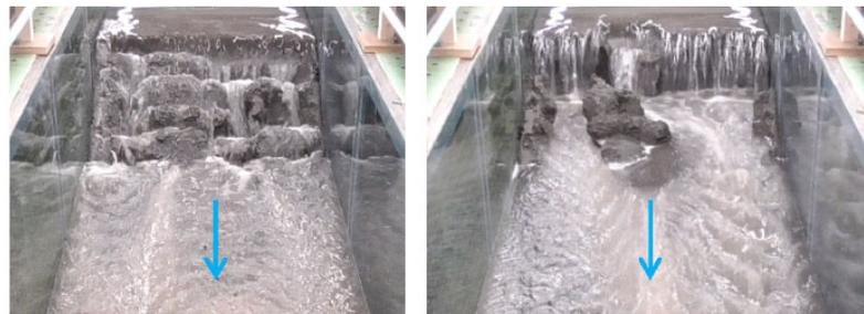
図-4 本実験 1 (裸堤) での堤体侵食状況(左写真は階段状に裏法面が侵食する様子、右写真は切り立った状態で天端が侵食する様子)
