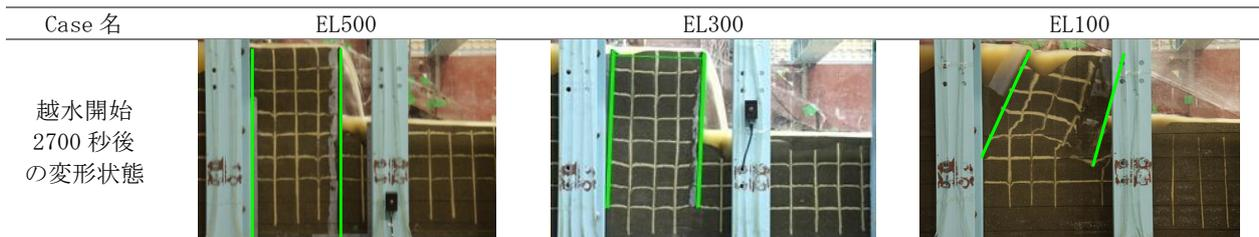
図3 越水開始2700秒後の変形状態
