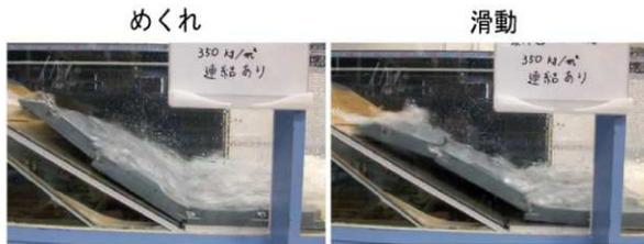
【ブロック（連結あり）破壊時の越流水深と流速】
