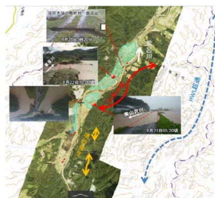
図-12 常呂川（セグメント2-1）の噴砂発生箇所
