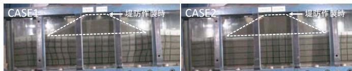
写真1 STEP4加振後の堤防の状況
