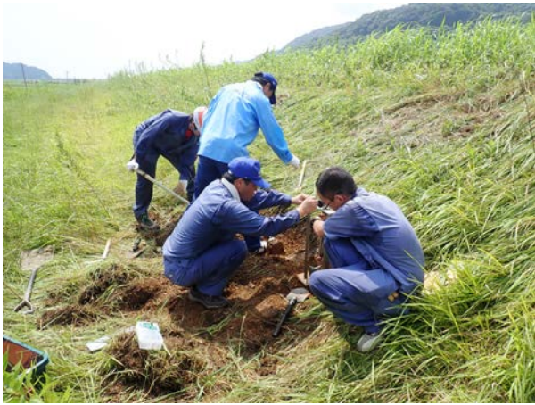
図-7 引張り破壊試験実施状況(牛津川左岸12.2k)
