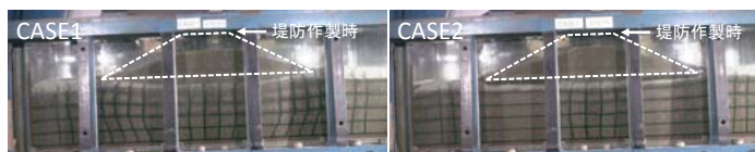
写真2 STEP5加振後の堤防の状況
