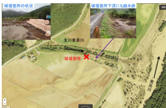
図-11 セグメント2-1における越水による決壊・破堤の事例
