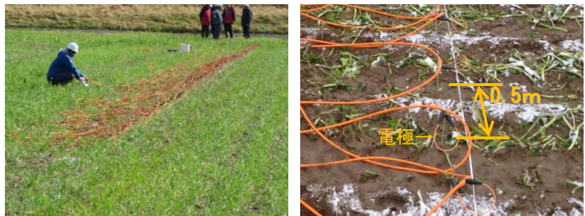
写真-1 電極設置型電気探査と測定状況
