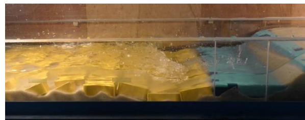
図-7 陥没する水叩き先端（大領域の模型実験）
