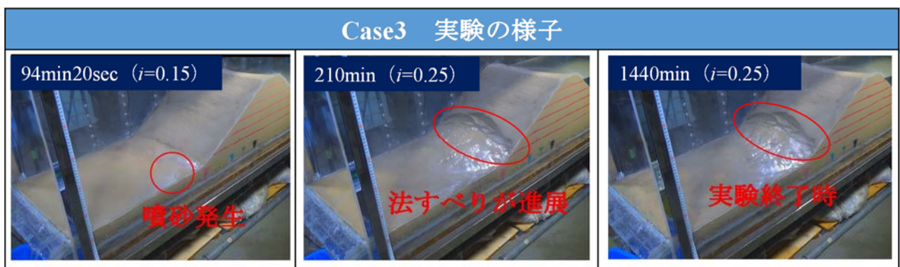
図-7 実験時の様子 (case3 堤体材料：硅砂7号)
