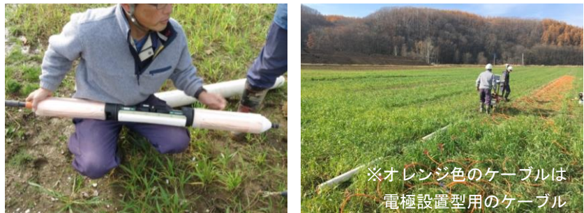
写真-2 改良版牽引式電気探査 (オームマップパー) と測定状況
