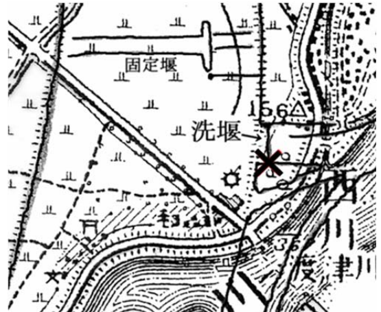
— : 1974年地形図 12) による洗堰と護岸等 X : 洗堰右岸漏水発生箇所
