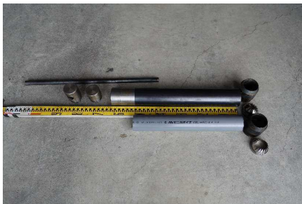
図4 2重管サンプラー
