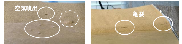
図- 4 豊浦砂、降雨強度80-90mm/hr時に見られたエアブローと亀裂発生の様子
