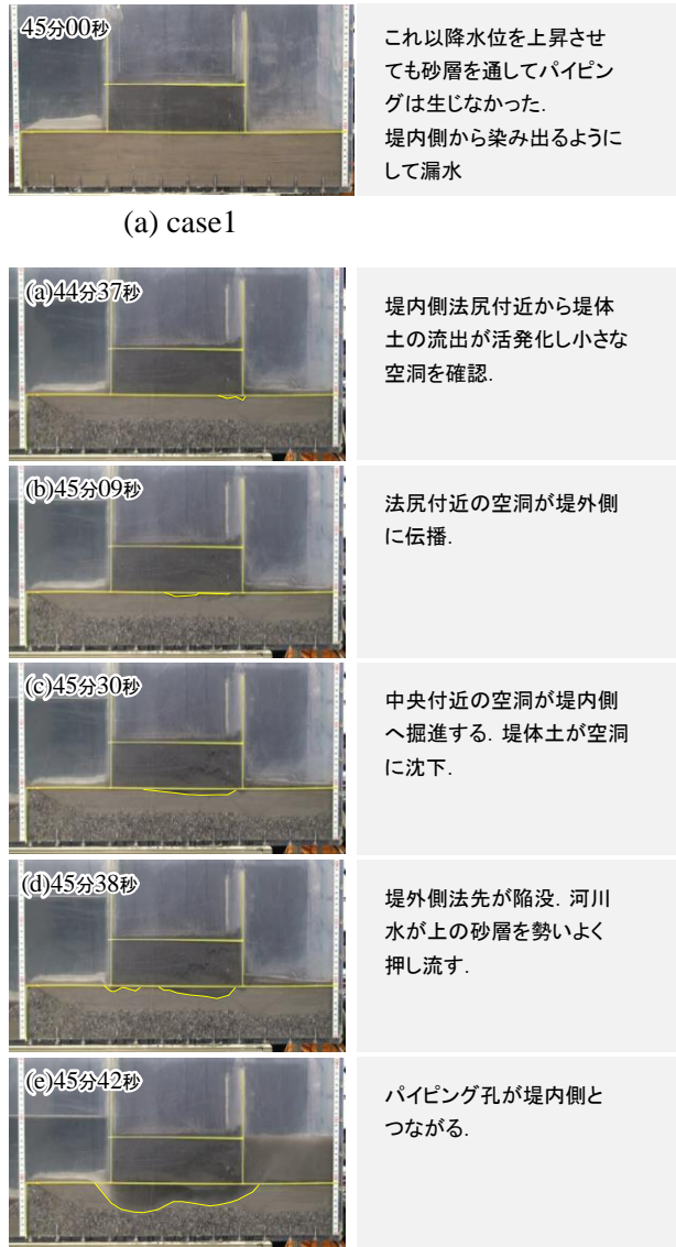
図4 パイピング発生時の様子
