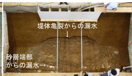
写真-1.2 【段階3】（亀裂から漏水）
