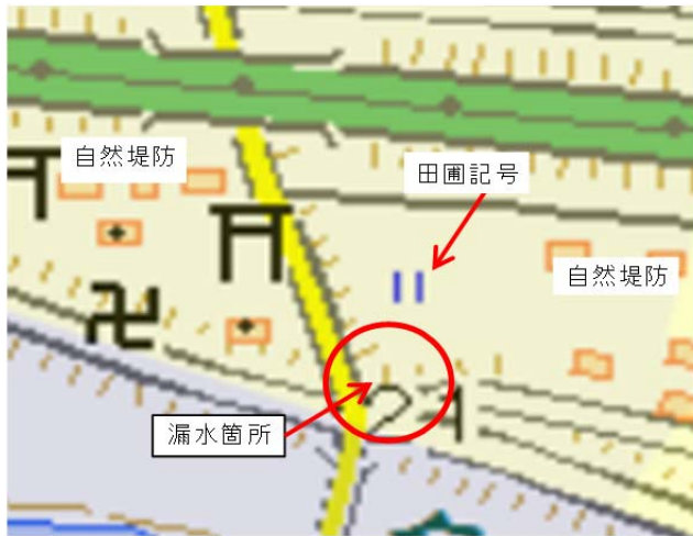
図-5 牧田川の漏水箇所付近の地盤状態(原図 9) に加筆)
