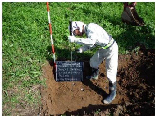
土層強度検査棒による簡易せん断試験
